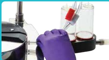
Kẹp được phân biệt màu sắc và được đánh dấu để tăng độ tin cậy khi sử dụng
